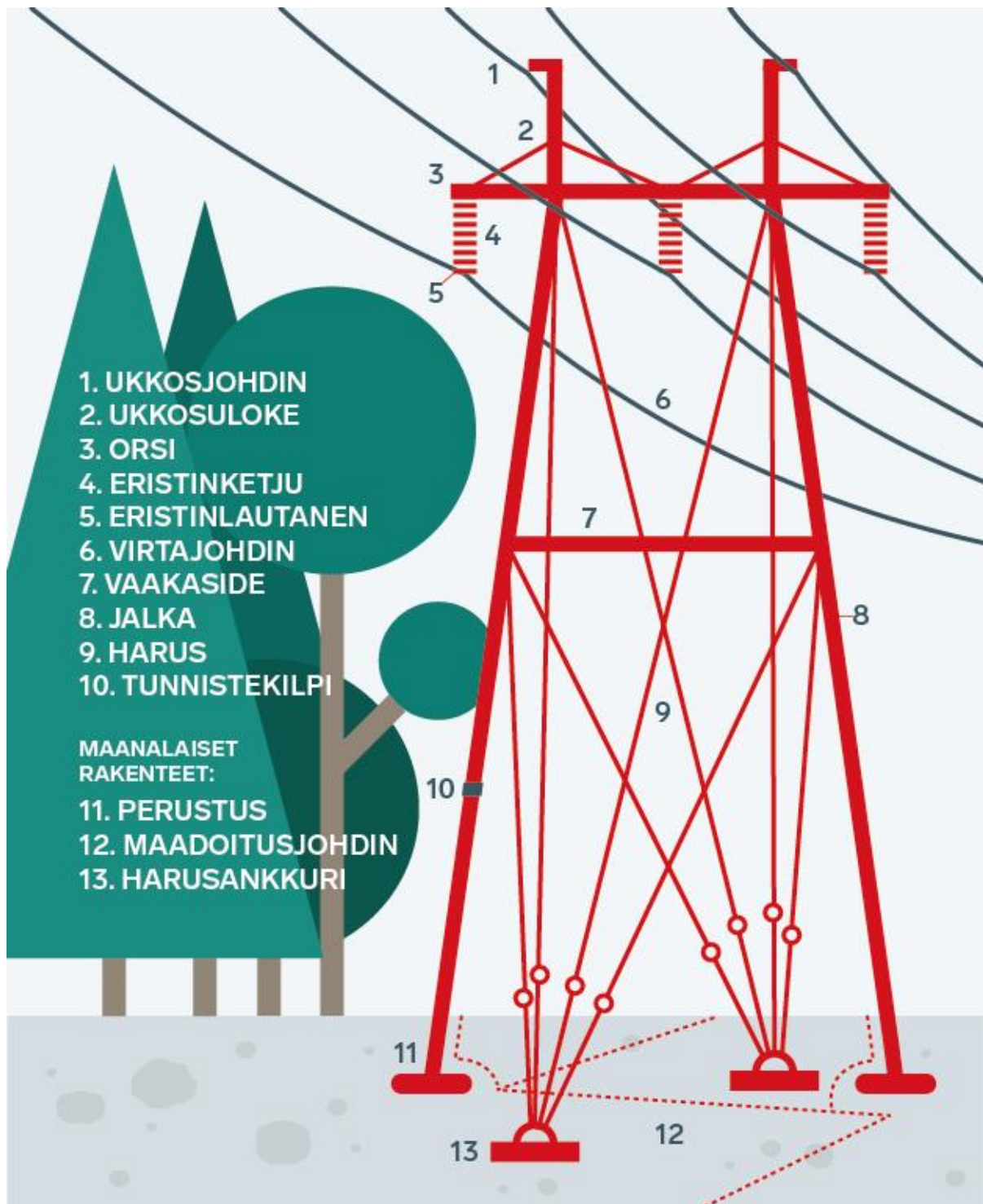
Kuva 2-7. Voimajohdon osat (Fingrid 2022a).
