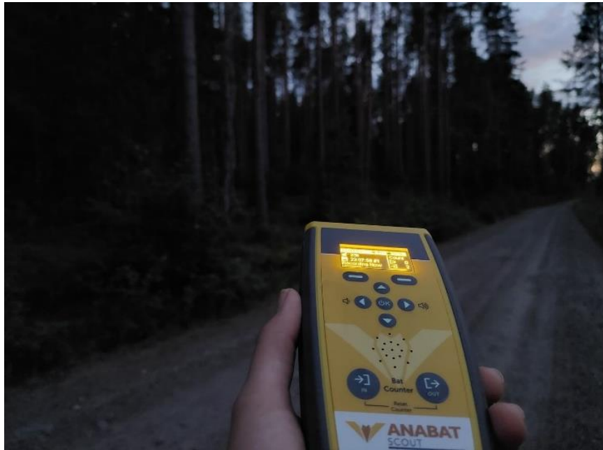
Kuva 5-1. Lepakkokartoituksessa käytetty Anabat Scout -detektorin havaitsee lepakkojen kaikuluotausääniä muuttaen ne ihmiskorvin kuultaviksi. Detektorin kertoo automaattisesti havaitun äänen korkeuden kilohertseinä, mikä avulla voidaan toteuttaa lajimääritys.
