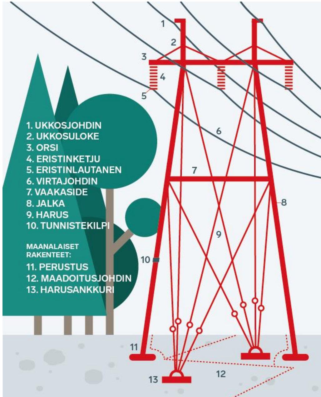
Kuva 7-5. Voimajohdon osat (Fingrid 2024).
